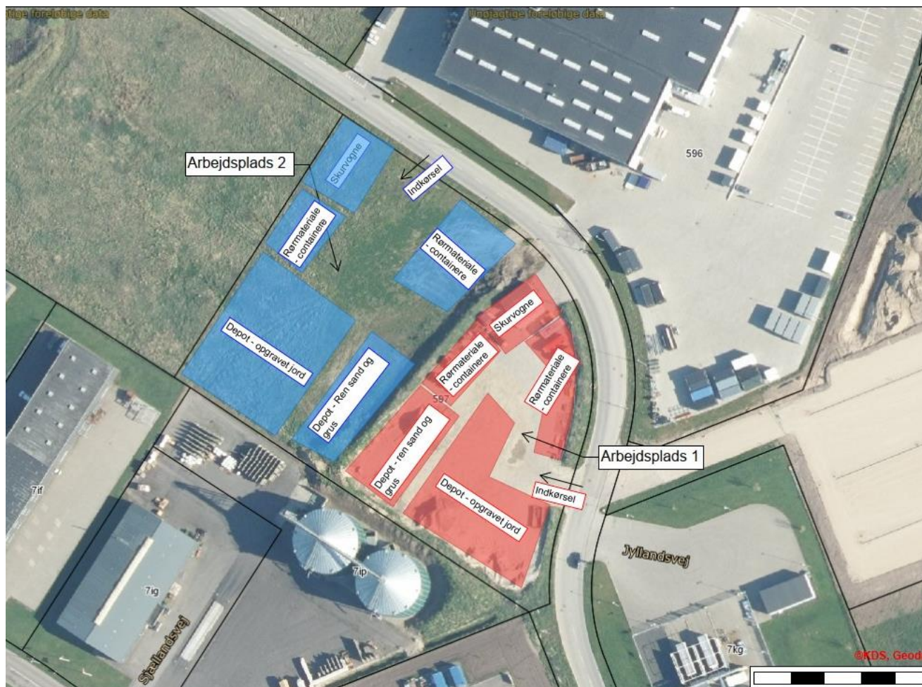
Figur 3: fremtidig indretning af oplagsplads.
