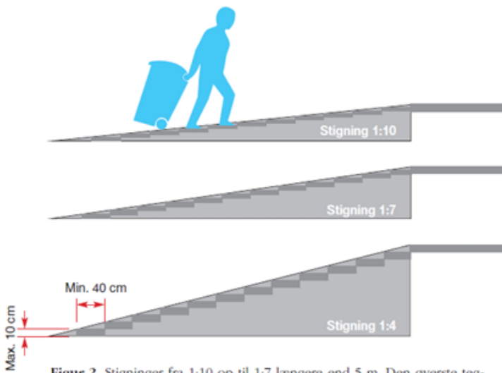
Figur 2. Stigninger fra 1:10 op til 1:7 længere end 5 m. Den øverste tegning illustrerer fx en hældning på 1 m over 10 m. Den nederste tegning illustrerer fx en hældning på 2 m over 8 m.
