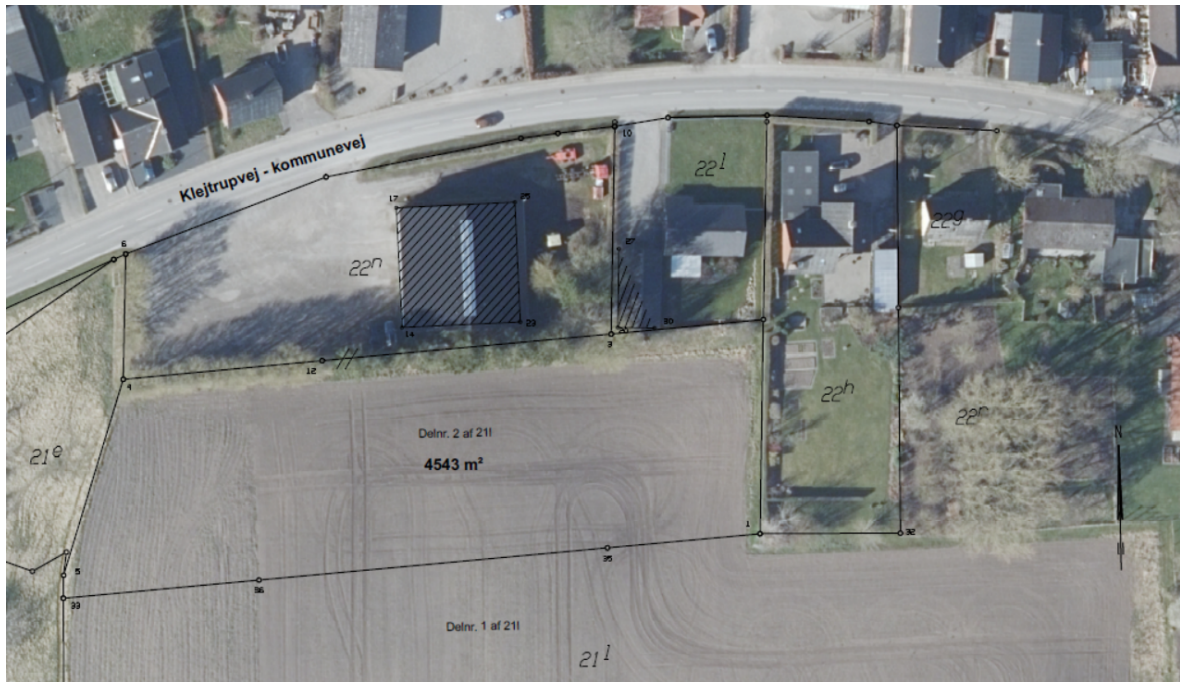
Figur 1: Måleblad der viser det areal (del 2 af 211) der overføres fra matr. 211, Hvornum By, Hvornum til matrikel 22n, Hvornum By, Hvornum.
