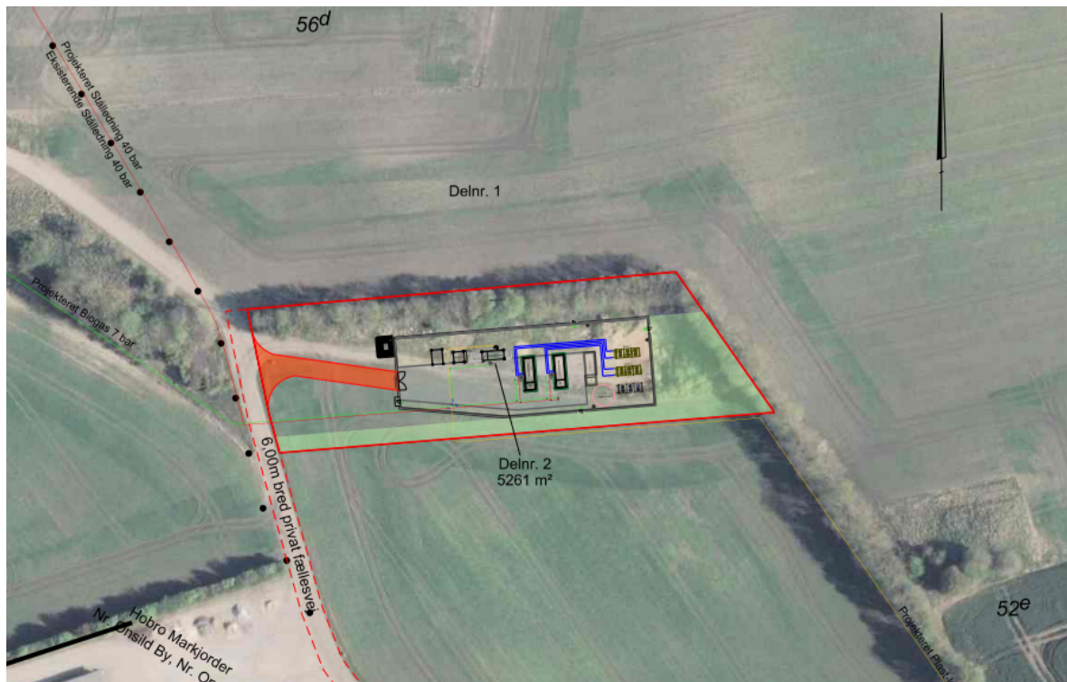
Figur 2: Areal til kompressorstation/udstykningsplan
