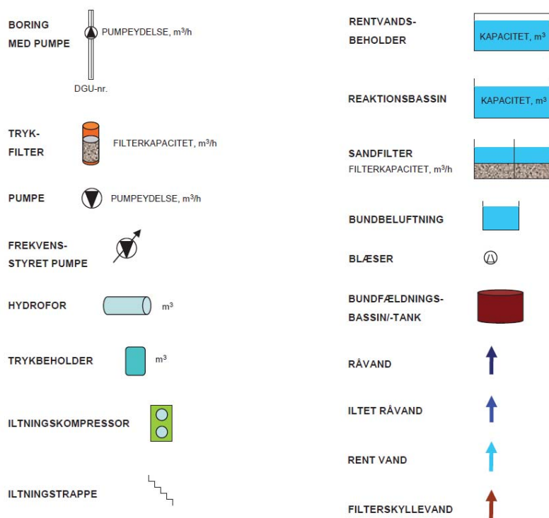
Fig. 1 Signaturforklaring til procestegninger.
