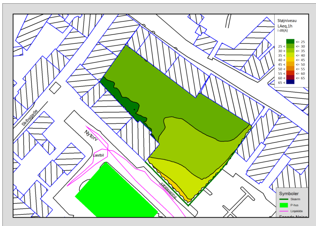
Figur 6. Støjkonturkort 1,5 m. over tagterrasse i aftenperioden med aftenlevering sit. 2.
